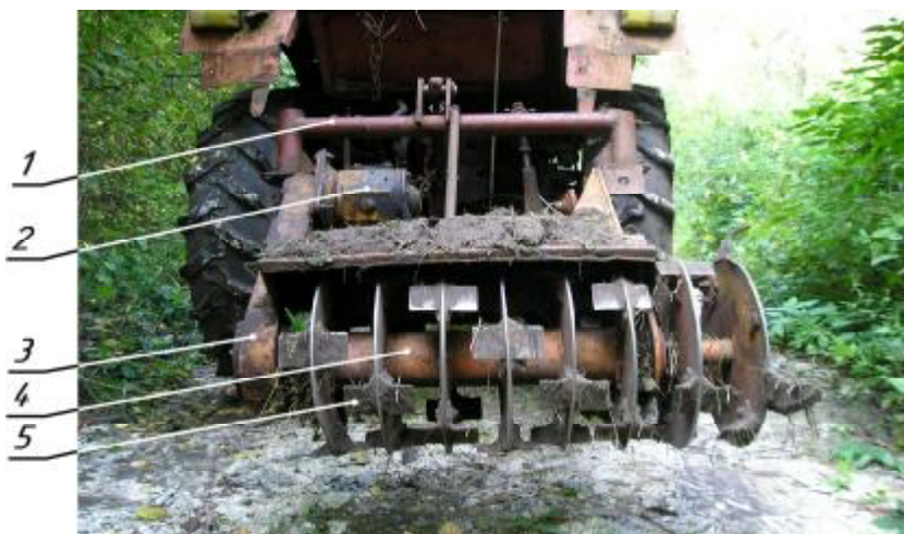
Рис. Фрезерний культиватор КФП-0.7: 1 – рама культиватора; 2 – редуктор; 3 – ланцюговий механізм; 4 – фрезерний барабан; 5 – ріжучі ножі
