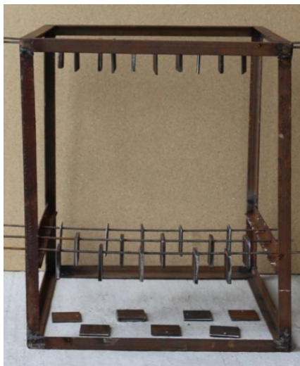
Рис. 1. Пристосування для розміщення дослідних зразків
