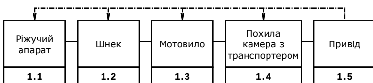
Рис.2. Структурна схема надійності жнивarki
