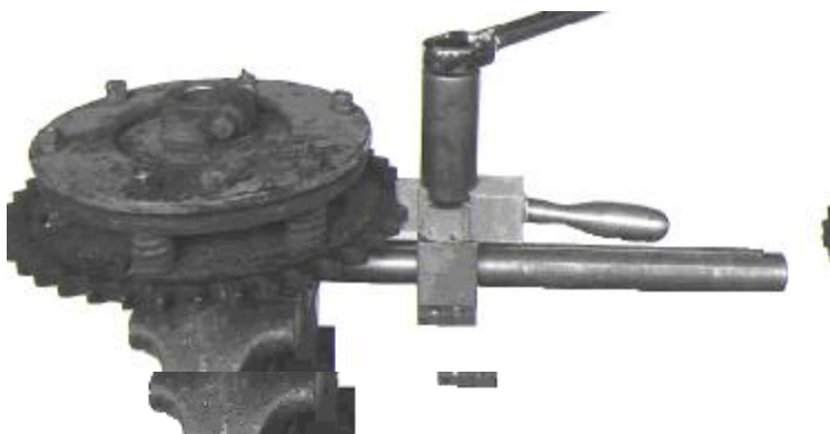
Рис.1. Загальний вигляд пристрою для визначення моменту спрацювання запобіжних муфт зернозбиральних комбайнів
